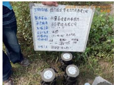
一樓樓版混凝土抗壓試驗試體。
