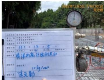
上圖/給水試水壓力合格。右圖/清涼內苑1F版筋試驗報告。
