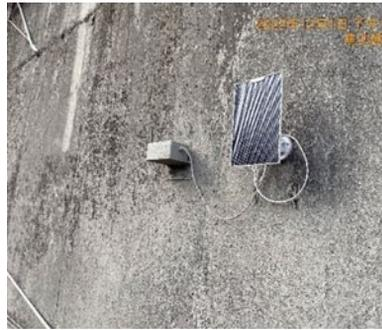
設置傾度盤掌握邊坡穩定狀況。
