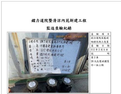
鐳力道院基礎地樑混凝土抗壓試體製作(拍攝日期:112年2月4日)。
