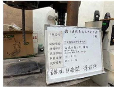
正在進行鋼筋拉伸試驗,確認鋼筋材料品質符合規定(拍攝日期:112年3月16日)
